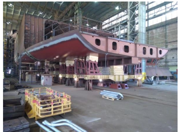
Днищевая секция готовая для начала ее позиционирования на стапеле.
