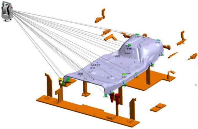
Контроль геометрии пола в стенде.
